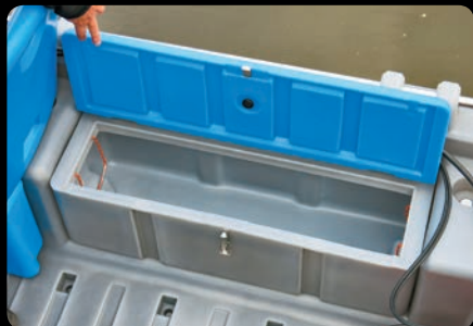
Vyjímatelný úložný prostor, který vzhledem ke své vodotěsnosti a omyvatelnému plastu může sloužit k mnoha účelům.
