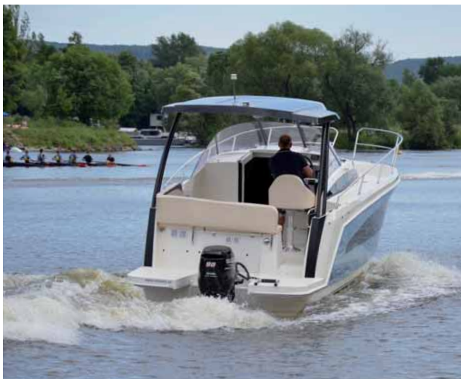
Netradičně řešená konstrukce zádě je v porovnání s klasickými výtlačnými loděmi odlehčená.
